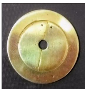
Figura 1: Matriz metálica bipartida contendo um orifício central e uma moldura periférica para fixar as duas partes centrais.
