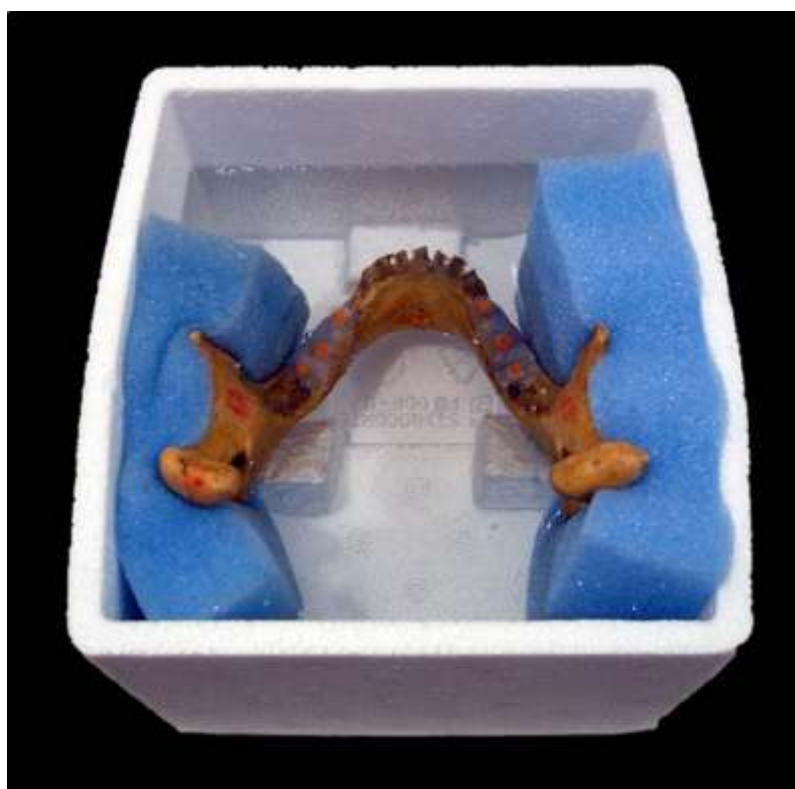
Figura 7 - Mandíbula imersa em água, posicionada e fixada na caixa de isopor - vista superior
