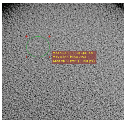
Figura 1 - Avaliação de ruído na imagem com base no desvio padrão dos valores de pixel evidenciando a granulação
