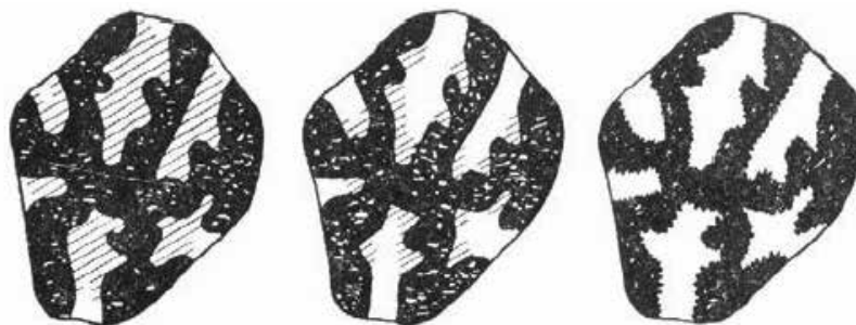
Figura 1 — Desenho do processo de ativação gradual do carvão durante a ativação física. Fonte: Mohammad-Khah; Ansari, 2009 14 .
