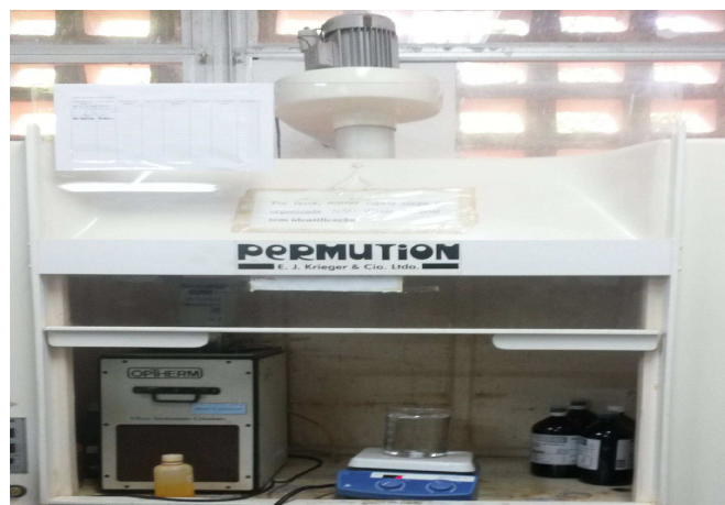
Figura 9. Capela Química de Exaustão
