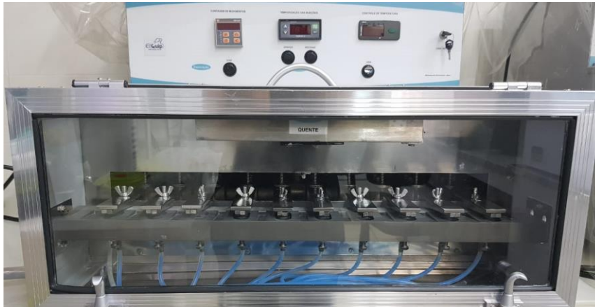
Figura 8- Máquina de escovação simulada.
