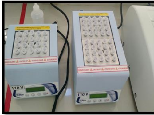
Figura 11- Aquecimento em bloco digestor.
