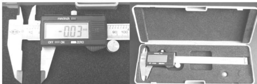
FIGURA 4 Paquímetro digital. (Fonte própria)
