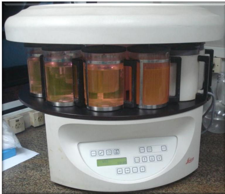
FIGURA 12 – Processador automático de tecidos (LEICA - Nussloch, Alemanha).
