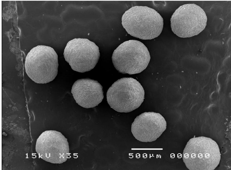
FIGURA 1 - Microscopia Eletrônica de Varredura da microesfera de hidroxiapatita.
